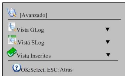
**Ver tiempo de conexión (registros de asistencia):** Son todos los registros de asistencia los cuales son generados cada vez que un usuario realiza una verificación o marca en el equipo. Presione la tecla “OK” sobre este ítem para ingresar a la pantalla de consulta, elija o coloque los datos deseados para visualizar las marcas de algún usuario en específico.
