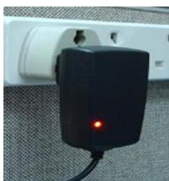
Una vez conectado el cargador al tomacorriente, presione el botón “power” (localizado en el teclado frontal del reloj) por 3 segundos para encender el equipo. Si cuenta con la opción de apagado automático, el dispositivo se apagará en el tiempo programado. Para el apagado manual solo presione el botón “power” por 3 segundos.
