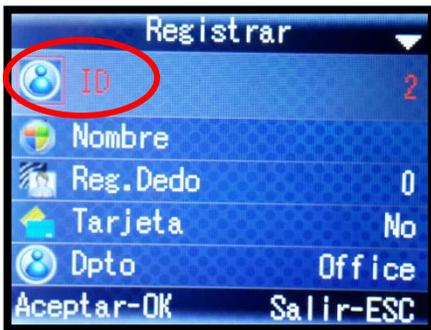
Por defecto el reloj mostrara el primer código sin usar, usted puede aceptarlo o digitar el de su preferencia. Para ingresar un nuevo código presione los botones numerales del teclado del reloj; por ejemplo, si ingresa el código de usuario 0000027, solo es necesario ingresar “2” y “7” y confirmar con la tecla “OK”.
