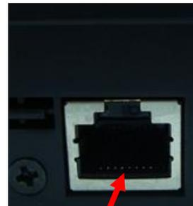
Puerto TCP/IP para descarga de datos y se localiza en la parte trasera del reloj
