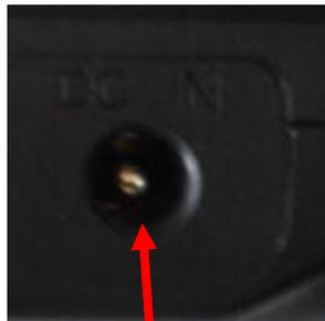
Alimentación 110V AC 12VDC y se localiza en la parte trasera del
